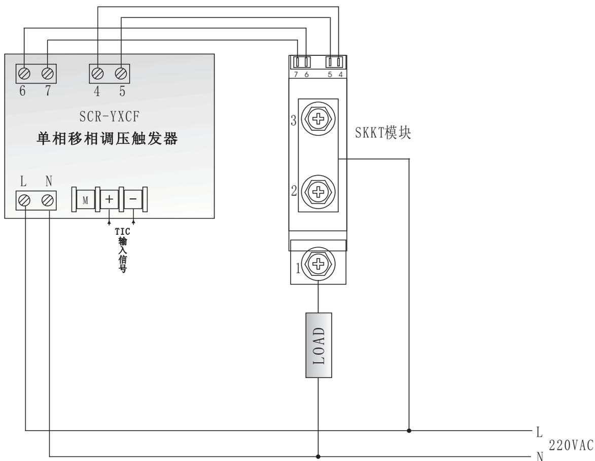
注：触发器和模块要同相，即图中L、N一定要对应，否则负载将失去控制。
